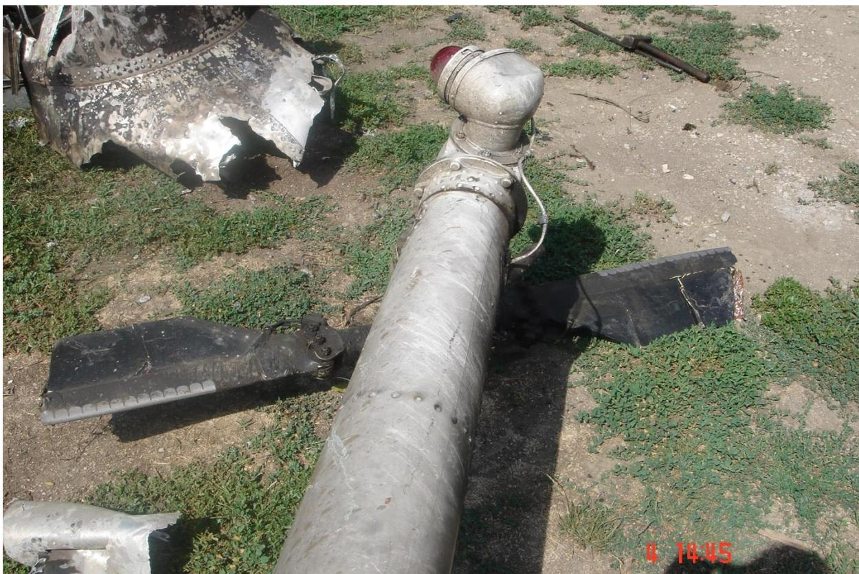
**Рис. 5. Состояние лопастей РВ после АП**
