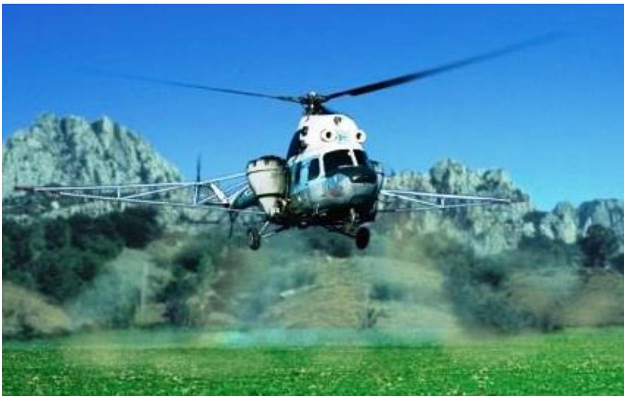
**Рис. 1. Вид вертолета Ми-2, оборудованного системой для выполнения АХР**
